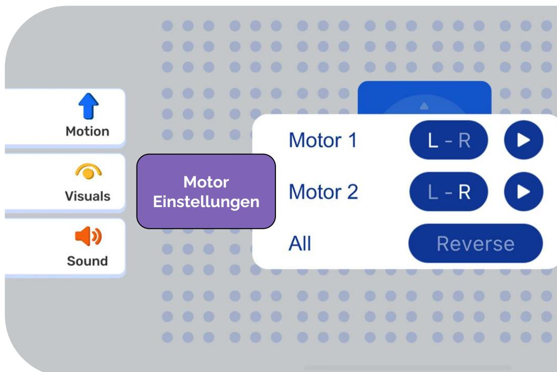
Tippe auf die Play-Taste, um die Motoren zum Drehen zu bringen und zu überprüfen, welcher Motor als #1 und welcher als #2 betrachtet wird. Verwende "L" und "R", um zu identifizieren, welcher Motor auf der linken und welcher auf der rechten Seite des Aufbaus ist.
