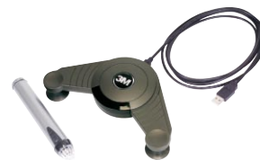
Elektronischer Whiteboard-Sensor mit Stift
